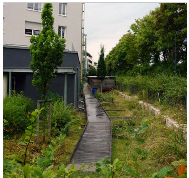
Durch eine geringe Versiegelung des Bodens kann mehr Niederschlag versickern.
